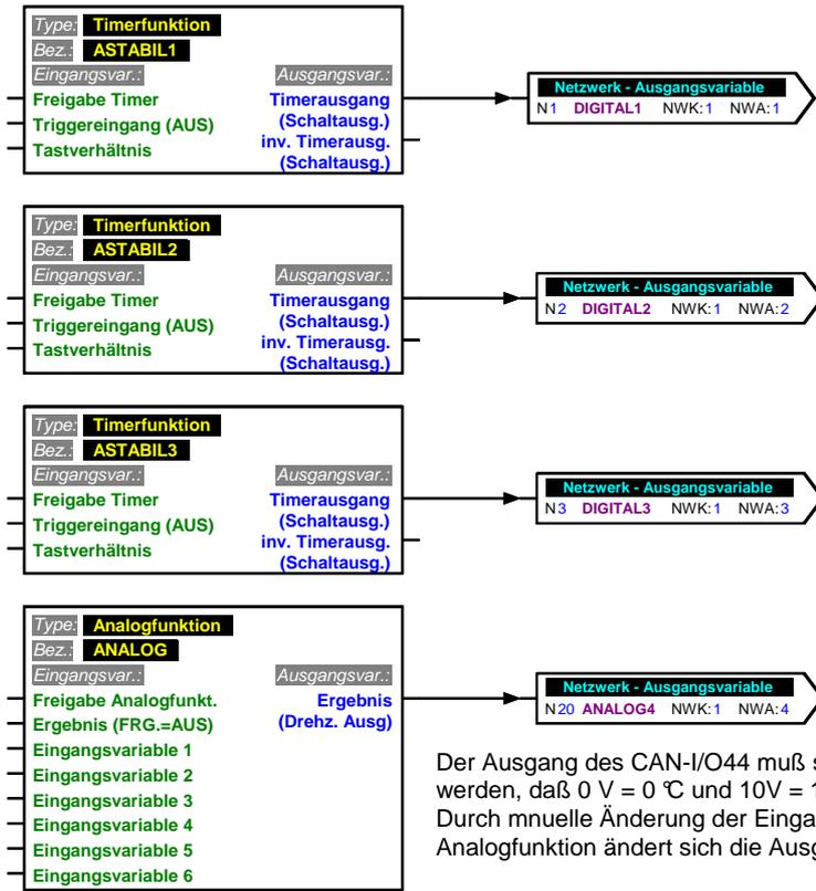
Der Ausgang des CAN-I/O44 muß so programmiert werden, daß 0 V = 0 °C und 10V = 100 °C entsprechen. Durch manuelle Änderung der Eingangswerte der Analogfunktion ändert sich die Ausgangsspannung.
